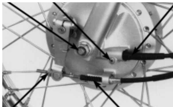
PORCA DE AJUSTE CABO DO FREIO
