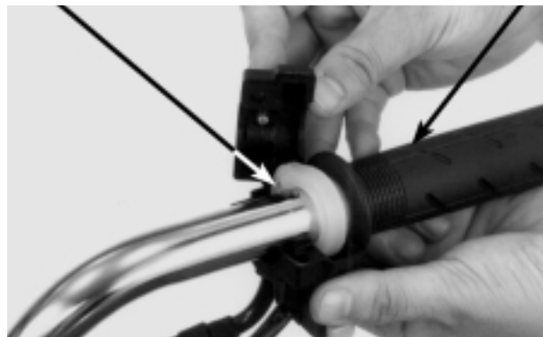
CABO DO ACELERADOR
