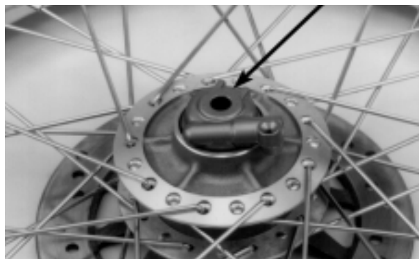
ESPAÇADOR LATERAL CAIXA DE ENGRENAGENS
