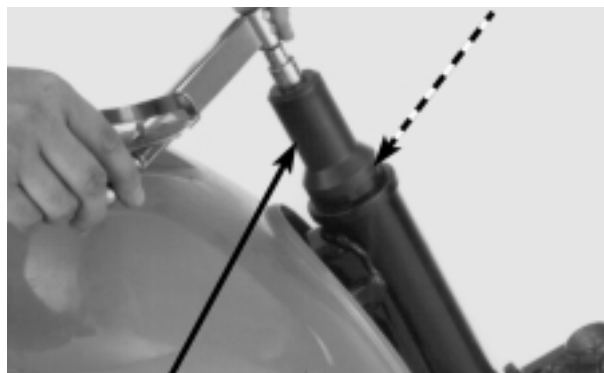
CHAVE-SOQUETE COLUNA DE DIREÇÃO
