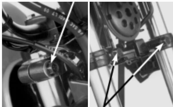
PARAFUSOS DE FIXAÇÃO DA MESA INFERIOR
