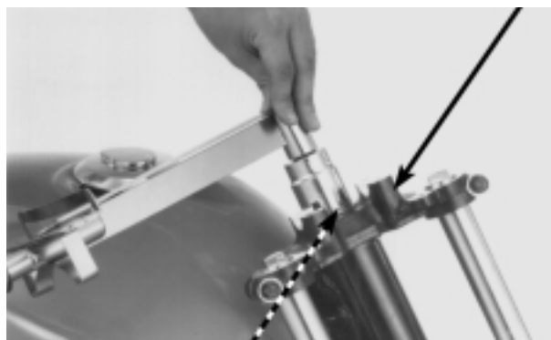
PORCA DA COLUNA DE DIREÇÃO
