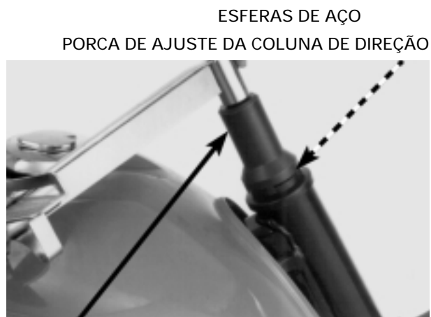
CHAVE-SOQUETE DA COLUNA DE DIREÇÃO
